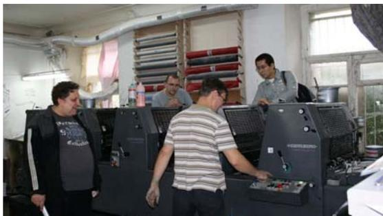
*Пробный пуск после замены и пегулировки валиков*
